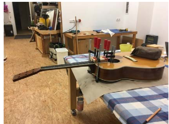
Bild 6: Neuausrichtung des Halses, Neuverleimung
