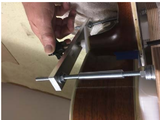
Bild 2: Damit sich der Hals lösen kann, wird gezielt etwas Druck auf die Verbindung gebracht
