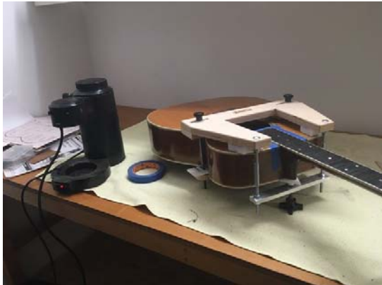
Bild 1: Die Gitarre befindet sich in einer stabilen Position, die Bundstäbchen wurden bereits entfernt
