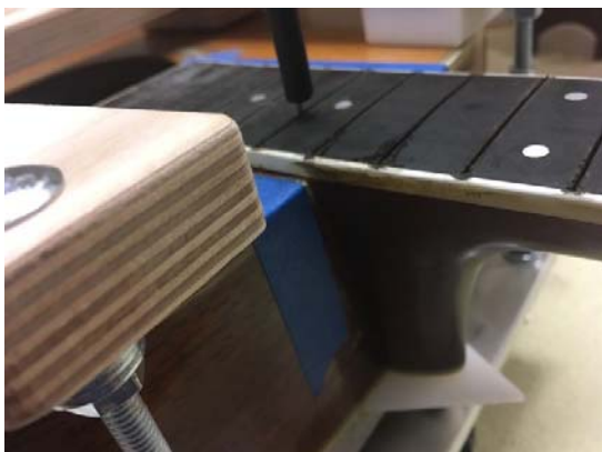
Bild 3: Bohren des Loches vor Einführen des Wasserdampfes
